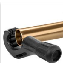
**Das Rohr mit einem Rohrschneider oder einer feinzahnigen Metallsäge sauber ablängen.**
