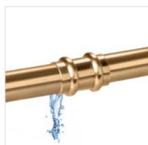
Die SC-Contur ist eine vom DVGW zertifizierte Sicherheitstechnik, die sicherstellt, dass eine Verbindung im unverpressten Zustand bewusst undicht bleibt. Dadurch werden versehentlich nicht verpresste Verbindungen während der Dichtheitsprüfung zuverlässig erkannt.
